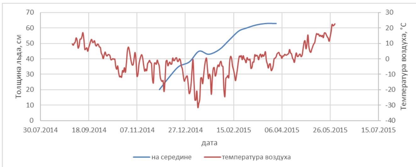
Рисунок 1.5 – Хронологические графики температуры воздуха и толщины льда на р. Северная Двина – г. Котлас, 2015 год
