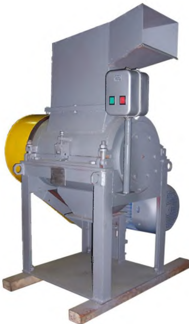
Рисунок 3.4 – Роторная дробилка ИПР-300М (производитель – ООО «АлтайСпецМаш»)
