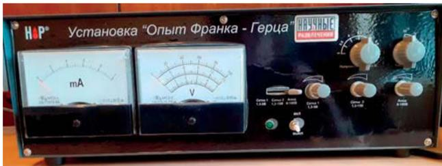
Рис. 2 Установка для проведения опыта Франка-Герца.
