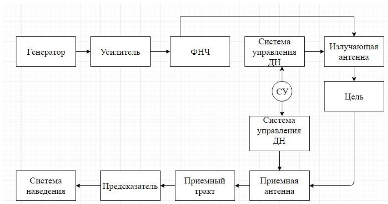
Рис. 3 - Структурная схема устройства системы наведения гидроакустического канала.
