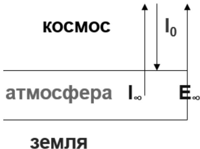
Рисунок 1.4 – Схема радиационного баланса поверхности и атмосферы
