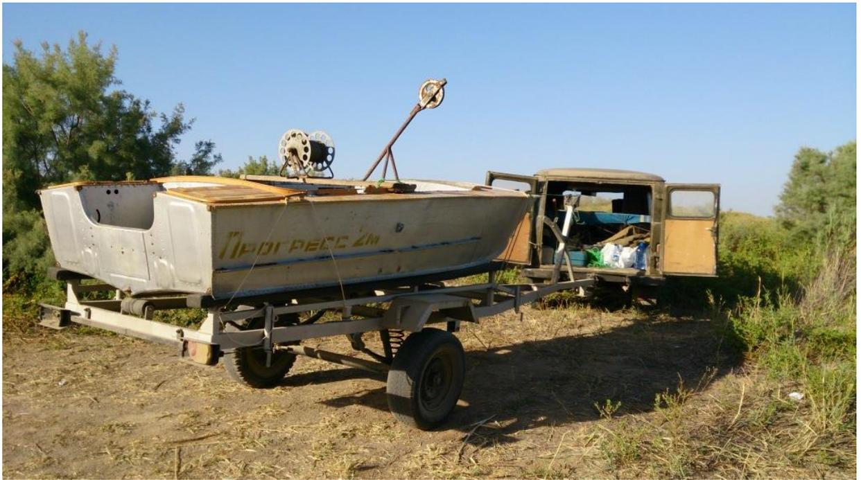
**Рисунок 6.1** – Моторная лодка типа “Прогресс-2” с установленной на ней гидрологической лебедкой, снабженной счетчиком С-52
