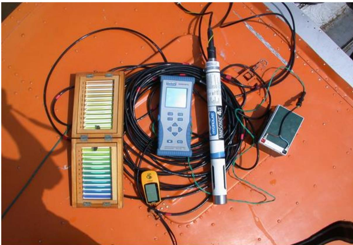
**Рисунок 6.2 – Зонд “Hydrolab”**
