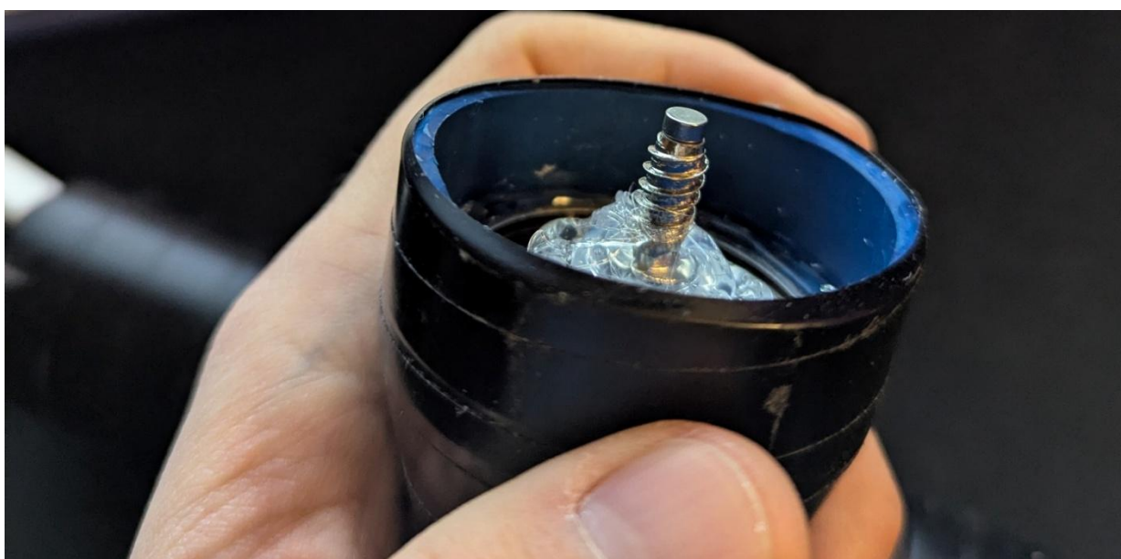
Рис. 8. Крышка корпуса. Виден стальной болт, закрепленный на ось. На болте находится магнит.
