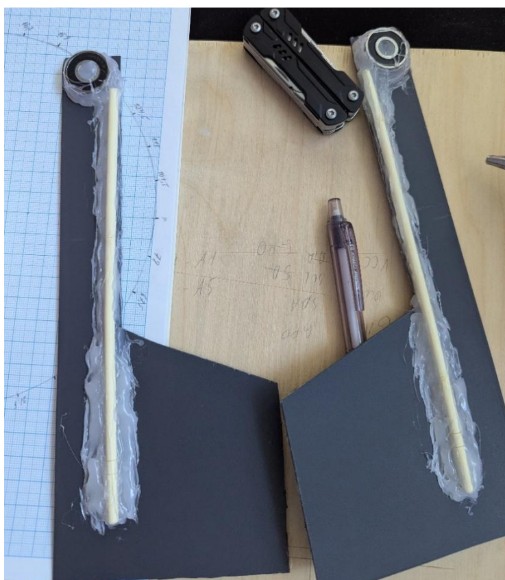
Рис. 12. Две части флюгарки.
