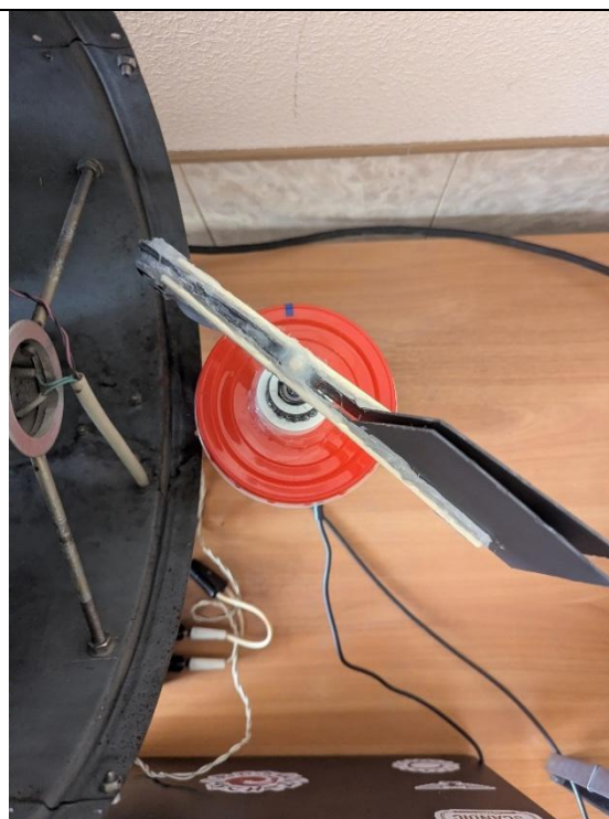
Рис. 27. Максимальный поворот флюгарки при данной скорости воздушного потока
