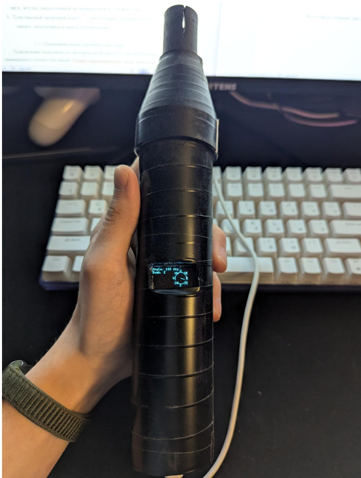
Рис. 6. Собранный первый прототип. Сверху видна ось с вертикальной прорезью для установки флюгарки, ниже на корпусе расположен дисплей, на который выводится информация.
