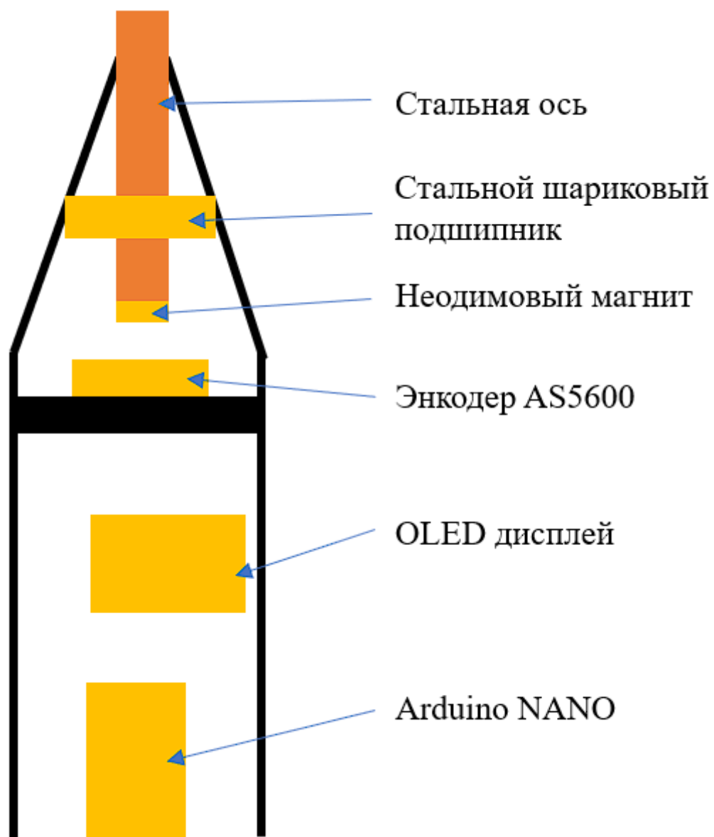
Рис. 2. Схема расположения элементов в корпусе.
