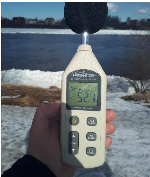
Рисунок 4.13 – Измерение шумоизлучения. Невский район. Точка исследования №10 (бульвар б/н на Рыбацком проспекте).
