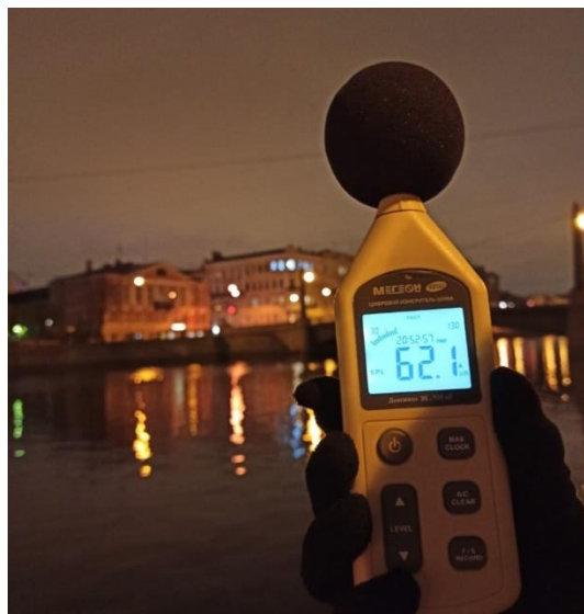
Рисунок 4.8 – Измерение шумоизлучения. Адмиралтейский район. Точка исследования №4 (Троицкая площадь).
