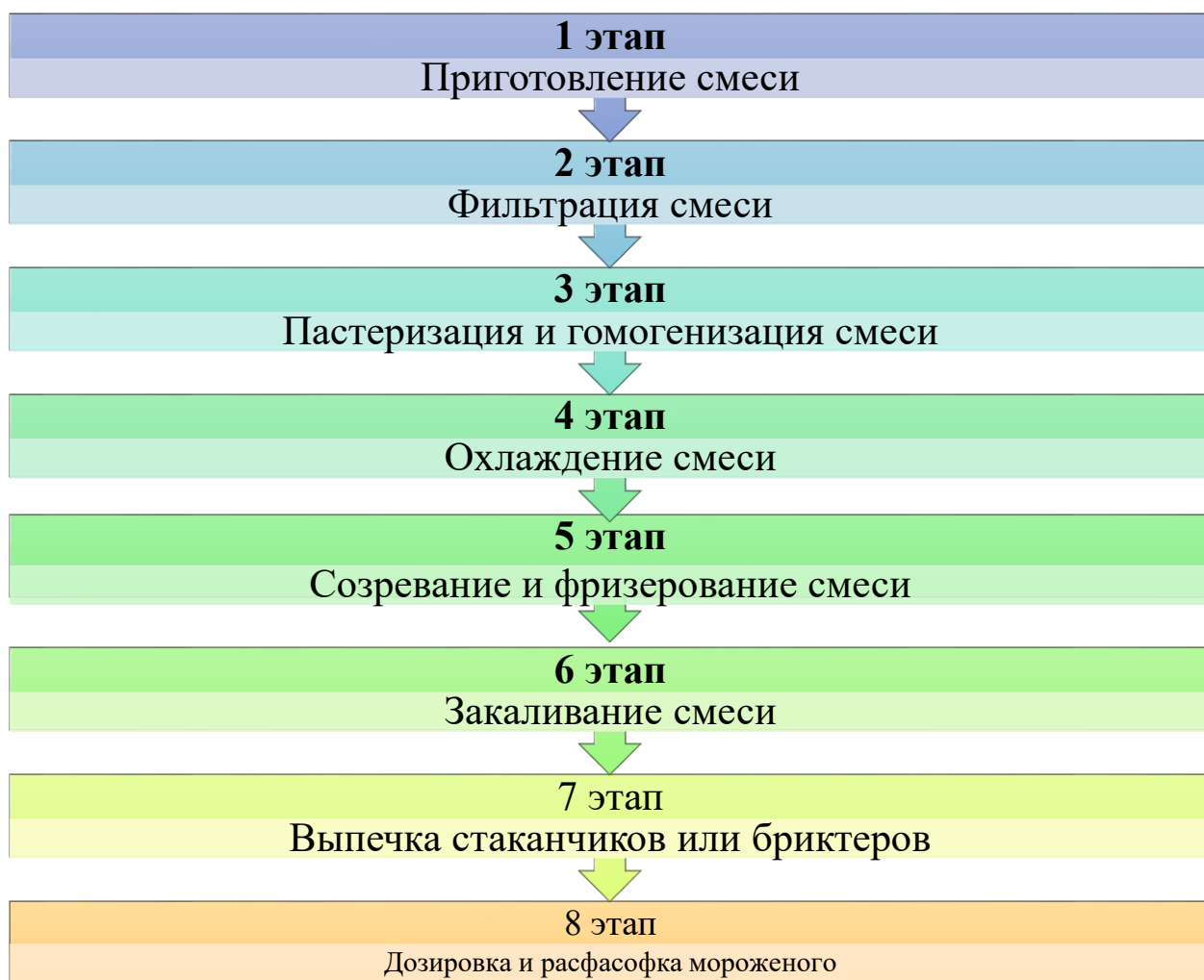
Рисунок 2.1 – Технологический цикл производства мороженого компании «Снежинка»
