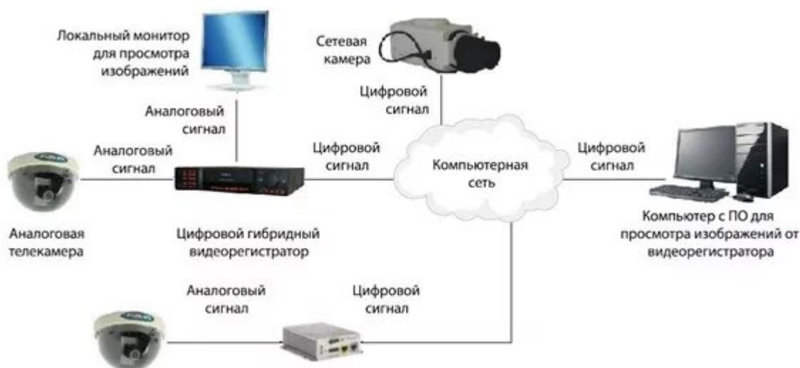
Рис. 1.14 – Гибридная система видеонаблюдения
