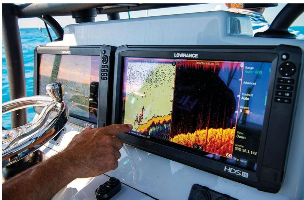
Рис. 1.5 – Эхолот, отображающий информацию о поверхности дна при плавании
