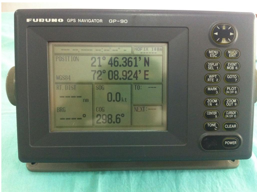
Рис. 1.11 – Спутниковая система навигации (GPS)
