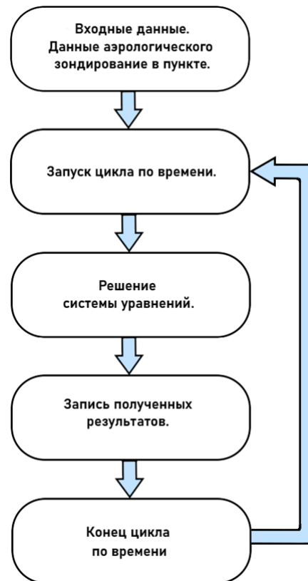
Рисунок 2.1 – Блок-схема гидродинамической модели облака
