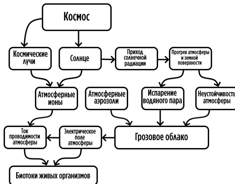
Рисунок 1.3 – Схема формирования электрического поля атмосферы Земли и электрических токов в атмосфере [1]
