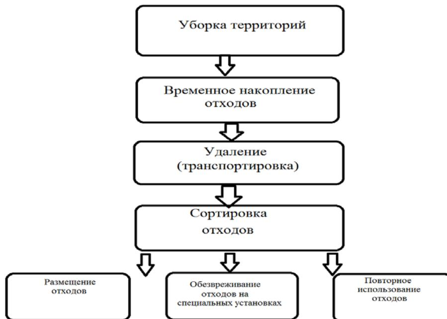
Рисунок 6 – Схема системы санитарной очистки и уборки территорий [3].
