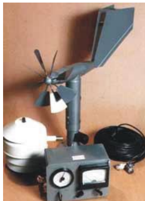
Рис. 7.22. Дистанционная метеорологическая станция М-49
