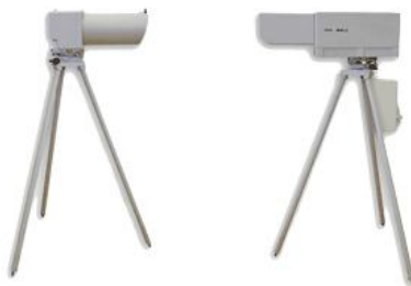
Рис. 7.21. Импульсный фотометр ФИ-3
