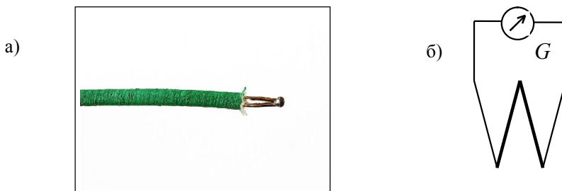
Рис. 1.20. Термопара а) спай термопары; б) схема
