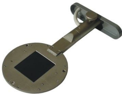
Рис. 5.7. Внешний вид балансомера М-10м
