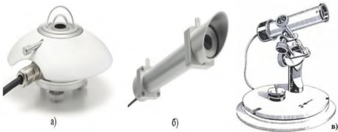
Рисунок 1.2 – Инструменты для измерения солнечного излучения, где а) пиранометр, используемый для измерения глобального излучения; б) пиргелиометр, используемый для измерения прямого нормального излучения (или лучевого излучения); в) актинометр, используемый для измерения интенсивности прямой солнечной радиации.
