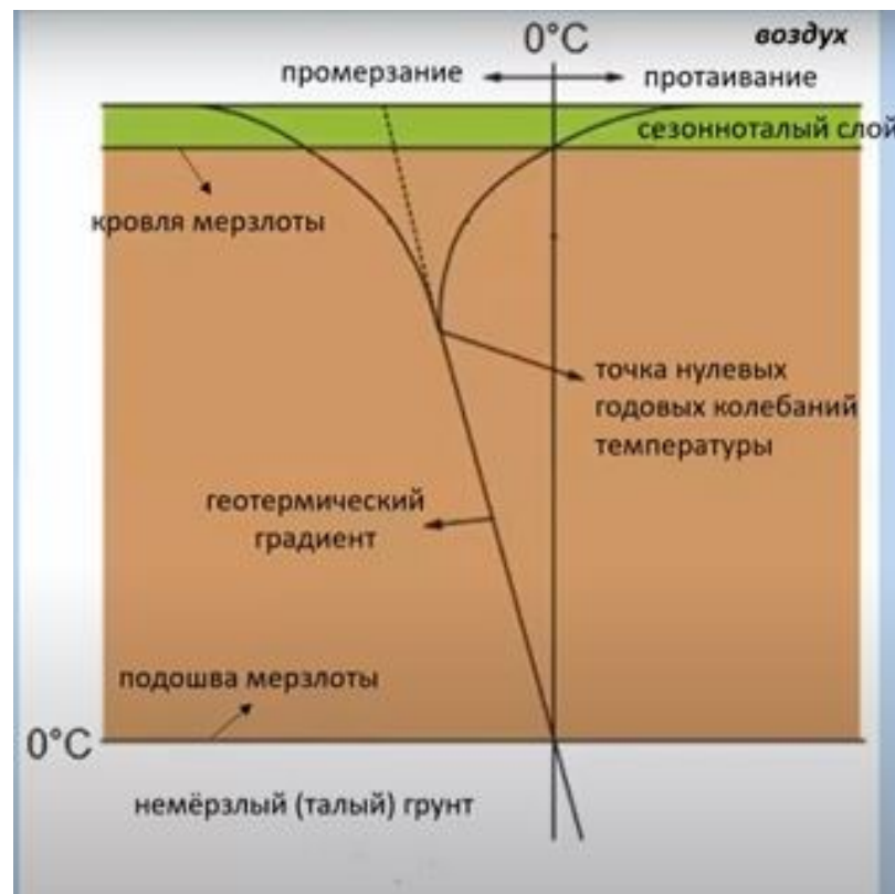
Рисунок 3 – Схема строения слоя вечной мерзлоты
