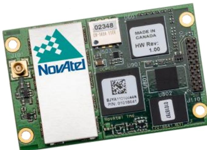
Рисунок 11 - Двухчастотный ГНСС-приемник Novatel OEM-615
