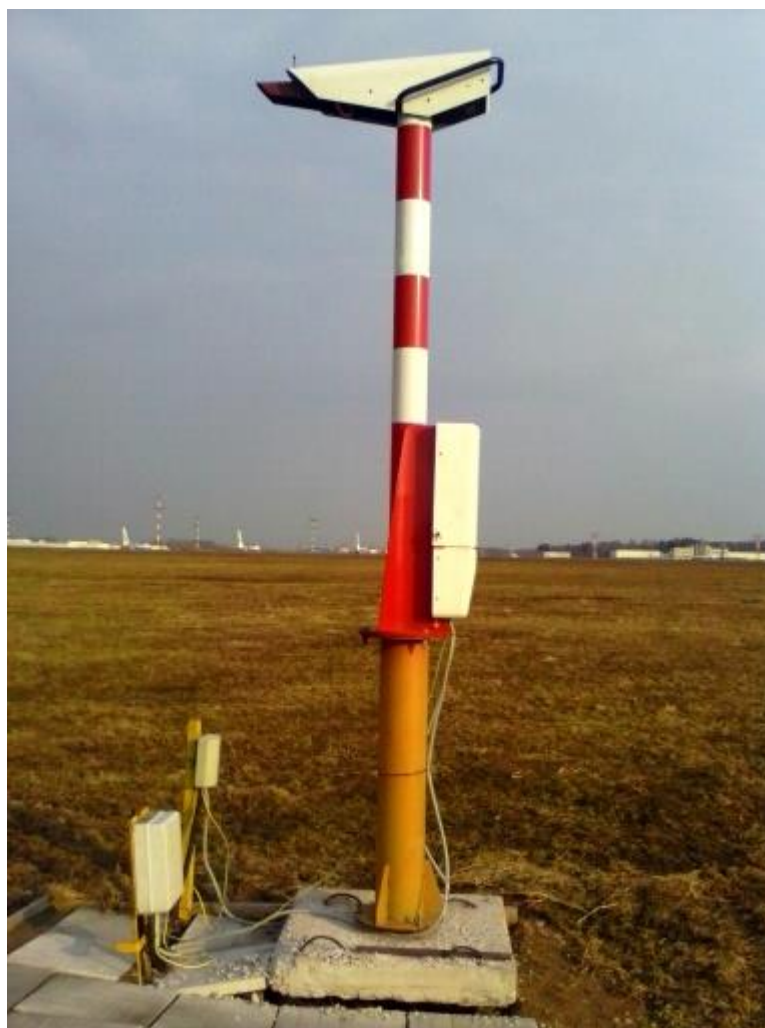
Рисунок 2.1 – Датчик трансмиссометра LT31
