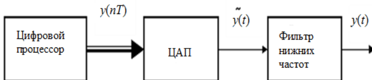
Рис. 8.1. Структурная схема, поясняющая место ЦАП в обработке сигнала
