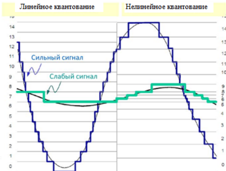
Рис. 6.3. Равномерное и неравномерное квантование сигналов
