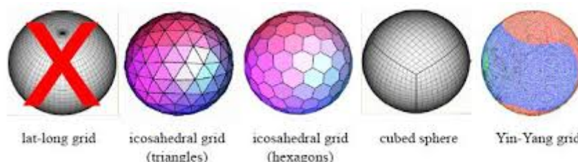
Рисунок 2.1 – Различные сетки, используемые в глобальных моделях атмосферы: широтно-долготная сетка, икосаэдральная сетка на основе треугольников, икосаэдральная сетка на основе шестиугольников, кубическая сфера, сетка Инь-Янь [2]
